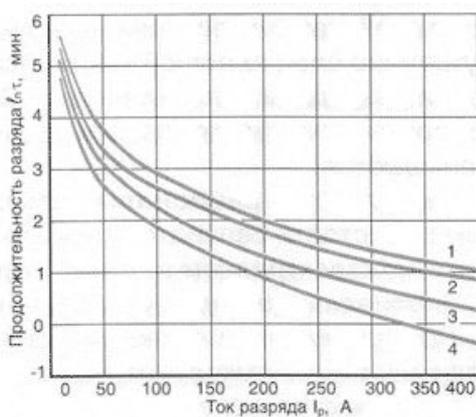
Рис.2 Зависимость продолжительности разряда необслуживаемой аккумуляторной батареи от силы тока при различных температурах:
