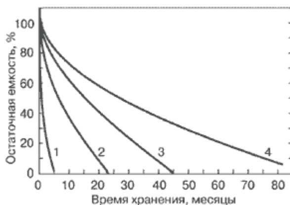
Рис.5. Действие температуры на остаточную емкость герметизированного свинцово-кислотного аккумулятора:
