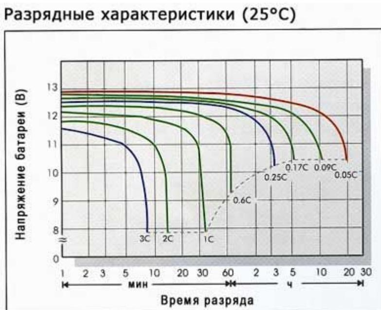
Рис.2. Разрядные характеристики герметизированной свинцово-кислотной аккумуляторной батареи
