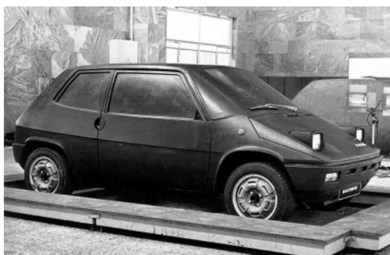
В 1979-80 годах АвтоВаз работал над электромобилем ВАЗ-2802 в грузовом варианте. С целью облегчения веса кабину сделали одноместной, раму и навесные детали из алюминия. Сварку вели методом точечной сварки. Дизайн Александра Дегтярёва. Вес машины 1140 кг, полезный груз 500 кг. Было изготовлено два экземпляра для опробования компоновочных решений.
